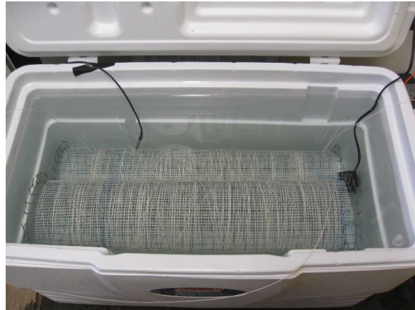
Abb. 1: Wasserbad des Laborversuchs: Auf den beiden Spulen waren unterschiedliche Abschnitte des Glasfaserkabels aufgewickelt. Außerdem ist rechts die Aquariumpumpe und links ein Pt-100-Sensor zur Messung der Referenztemperatur zu erkennen.
