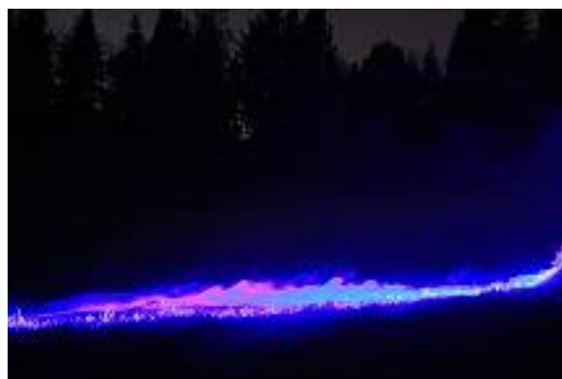
Abb. 15: Kaltluftabfluss auf der Wiese am 20.04.2015, visualisiert mit freigesetztem Nebel und Laserlicht.
